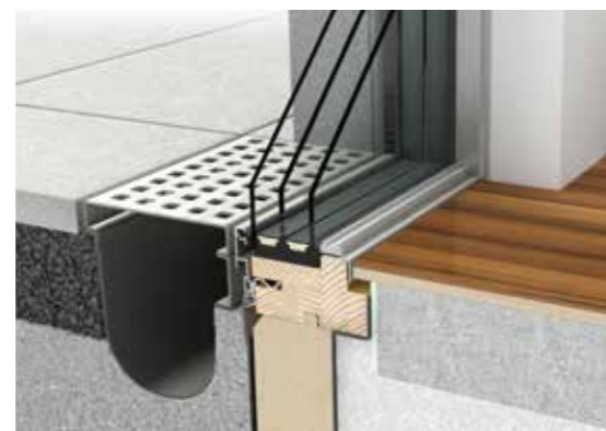
Bezrámový vzhled a technologicky optimální stavební připojení
